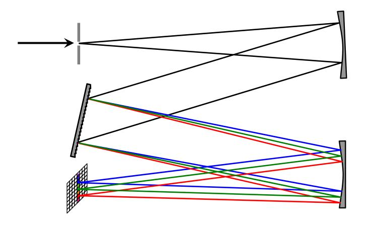
Le réseau de diffraction permet d'établir une correspondance entre composante spectrale et coordonnée spatiale, ce qui permet de mesurer le spectre  $|E(\omega)|^2$  à l'aide d'une caméra CCD.
