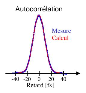
Le bon accord entre l'autocorrélation mesurée et l'autocorrélation calculée à partir du spectre mesuré (en supposant une phase nulle) indique que  $\Delta t^2 = \Delta t_{\omega=0}^2$ .
