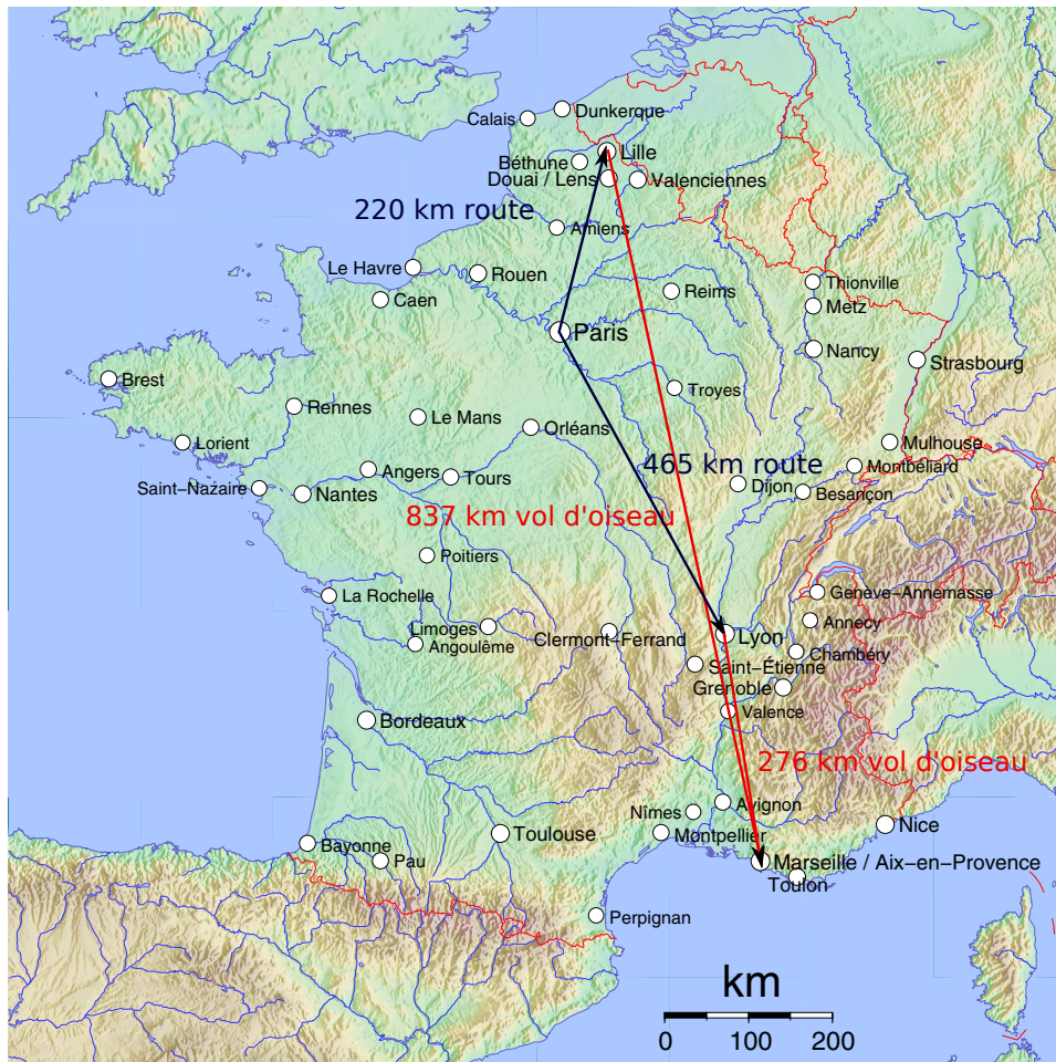
FIGURE 1 – L’algorithme de Dijkstra, partant de Paris, va d’abord parcourir Lille (distance routière depuis Paris : 220 km) avant de parcourir Lyon (465 km). En revanche, A* va d’abord parcourir Lyon (distance routière à Paris + distance à vol d’oiseau à Marseille : 741 km) et ne parcourra pas Lille (distance routière Paris–Marseille : 775 km, inférieure à Lille – Marseille à vol d’oiseau : 837 km).
