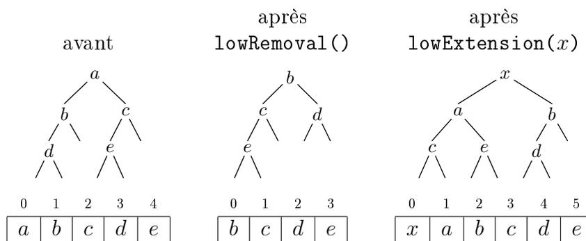
On prendra le temps de bien comprendre ce qui se passe ici. En particulier, on observera comment les éléments passent d'un côté à l'autre de l'arbre. En effet, les éléments situés à des indices pairs (resp. impairs) avant se retrouvent à des indices impairs (resp. pairs) après.
