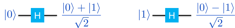
FIGURE 10.15 – Effet d'une porte de Hadamard sur les deux états de base d'un qubit.
