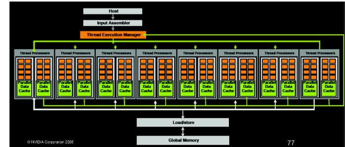
(ici 128 threads procs. pour 4 multi-procs de 32 coeurs) L'hôte peut charger des données sur le GPU, et calculer en parallèle avec le GPU
