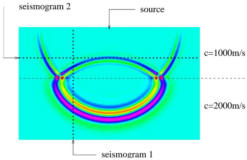
FIG. 3 – Propagation d'une onde dans un sous-sol
