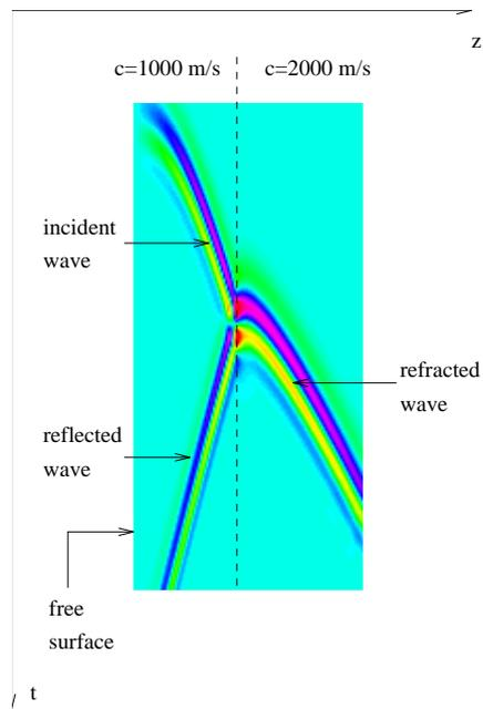
FIG. 4 – Sismogramme pour un puit vertical
